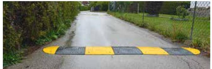
Plastikschwellen zur Temporeduktion am Schlägelweg.
